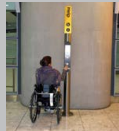
✅ Borne d'appel avec bouton-poussoir à bonne hauteur
